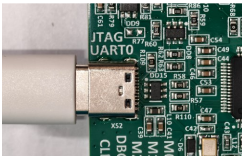
Рисунок 3 – Разъем для подключения в режиме JTAG/UART0
